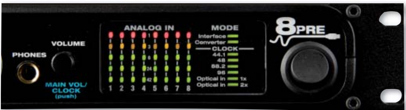
Das multifunktionale Volumen-Poti ermöglicht alle Einstellungen über ein einziges Bedienelement.
