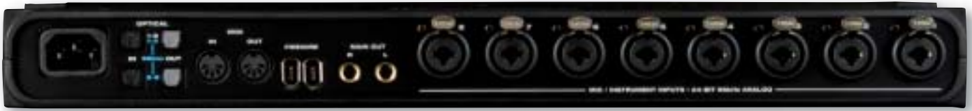
Außer den acht XLR-Klinke-Kombibuchsen verarbeitet das ADAT-Modul digitale Signale mit bis zu 96 Kilohertz: SMUX macht's möglich.
