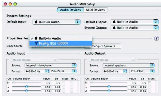
In diesem Fenster kann der Anwender die Eigenschaften und Einstellungen für das FIREFLY 302 den eigenen Bedürfnissen anpassen. Es können beispielsweise die Sampling Frequenz oder Clock Source geändert werden. Sie können auch bestimmen, dass FIREFLY 302 das Standard Audio Gerät im Eingang und Ausgang wird.
