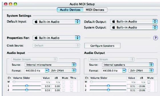
Gehen Sie in die Sektion „Audio Geräte“. Wählen Sie im Pull Down Menü „Properties For“ das FIREFLY 302.
